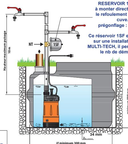
RESERVOIR 1SF INOX à monter directement sur le refoulement en tête de cuve. prégonflage : 1.2 bars.
