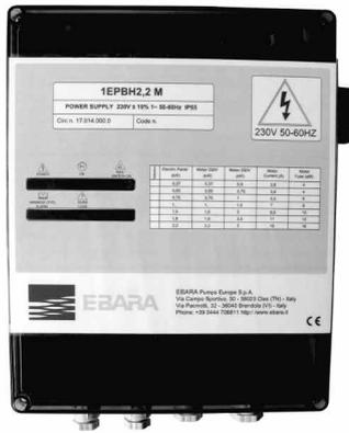
Tableaux de protection et de commandes pour une électropompe submergée ou de surface à démarrage direct. Le tableau est prévu pour commander manuellement et automatiquement une électropompe. Au cours du fonctionnement automatique, la commande de l'électropompe est donnée par le pressostat, par le flotteur ou par les autorisations provenant des électrosondes ou des flotteurs.
