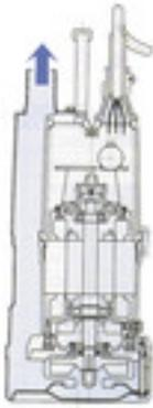
L'eau pompée refroidit le moteur et est refoulée comme illustré ci-contre. Le refroidissement du moteur est également assuré en pompant très peu d'eau. Le refolement par le dessus permet l'accès à des espaces réduits.
