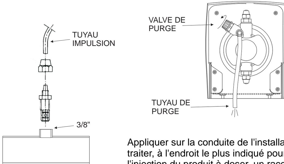
Appliquer sur la conduite de l'installation à traiter, à l'endroit le plus indiqué pour effectuer l'injection du produit à doser, un raccord en acier de 3/8 " gaz femelle.
