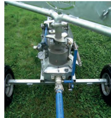
Fermeture automatique en bout de course par coupure de vanne
