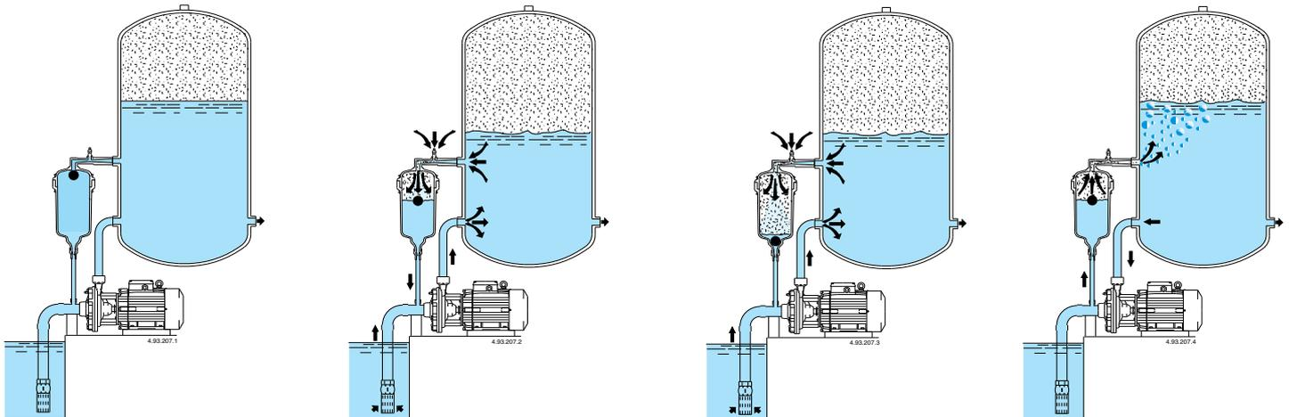
1) Lorsque la pompe est à l'arrêt, le réservoir de l'ARIAMAT est plein d'eau.
