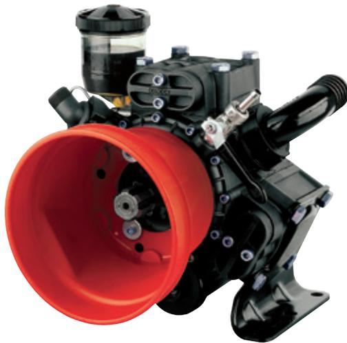
Pompe à **trois** membranes semi-hydraulique avec chambre à air pour le secteur de l'agriculture professionnelle. Recommandée particulièrement pour la haute pulvérisation dans les vergers et vignobles. Le corps de pompe est en aluminium et toutes les parties en contact avec des liquides de pulvérisation sont anodisées.
