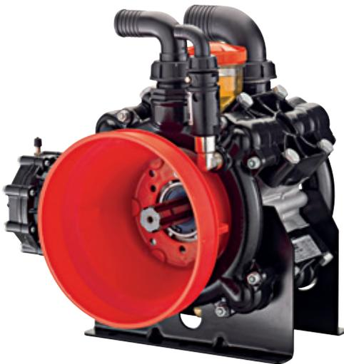
Pompe à **quatre** membranes semi-hydrauliques avec chambre à air et soupape de sécurité. Toutes les parties en contact avec des liquides de pulvérisation sont en aluminium revêtu de matière plastique et d'acier inoxydable.
