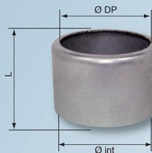
Les jupes de sertissage permettent de réaliser une liaison très fiable et efficace entre la douille d'un raccord et l'extrémité d'un tuyau. L'assemblage est réalisé au moyen d'une presse permettant de sertir radialement avec des mors concentriques ou par filage au travers d'une matrice. Le profil des jupes 5005 est spécialement adapté aux tuyaux ARMETA.
