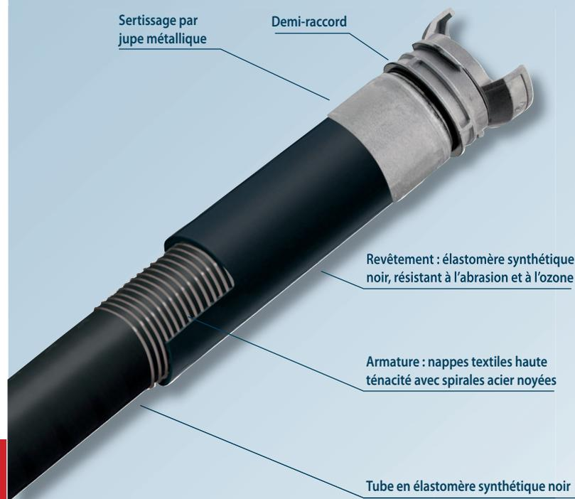
Flexible composé d'un tuyau d'incendie pour l'aspiration « ASPIRAUX » branché en amont des pompes, permettant l'alimentation des engins pompes. Il est également conçu pour fonctionner en refoulement. Plage d'utilisation -30°C à +80°C.
