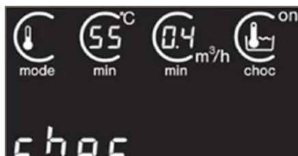
Quand un cycle thermique de désinfection est détecté par le circulateur et la routine est lancée, les données de fonctionnement standard sont remplacées par le mot « choc ».
